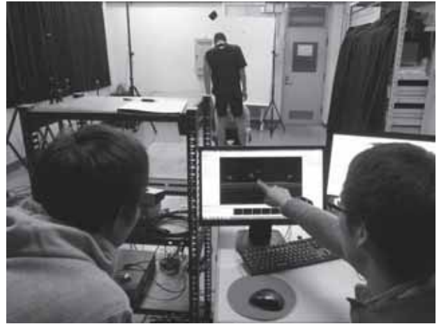
写真1 体の9か所にマーカーを付け、マーカーの動きがパソコンの画面上で映し出される
